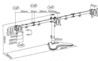
Dreifach-Monitorarm mit Standfuß - Abmessungen
